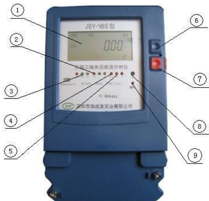
图二 失压断流计时仪外观图
