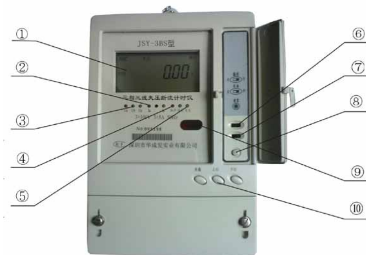
图二 失压断流计时仪外观图
